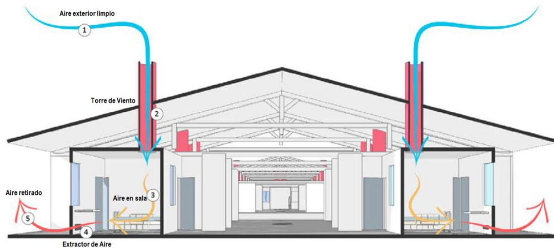
Figura 9. Sistema híbrido de ventilación y extracción instalada en áreas para internación de Infecciones respiratorias agudas. Debe tenerse cuidado de ubicar los orificios de ventilación lejos de los de extracción porque de otro modo puede originar el fenómeno de cortocircuito y facilitar la recirculación de aire contaminado. Permiso CC BY-NC-SA 3.0 IGO de OMS. (82)
