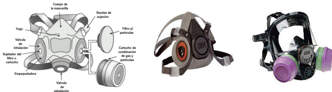
Figura 16. Respirador elastomérico y componentes. Notese como los diferentes componentes y los filtros (Fig. Trad. RPE Code of Practice – Part 1; University of Alberta, Environment, Health & Safety). A derecha dos modelos diferentes: “media cara” o “facial total” (Descargada de Web).
